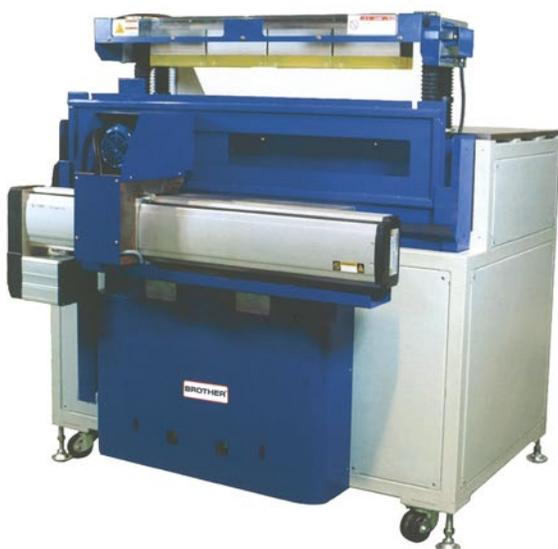
CNCダブテールマシンは、多彩で簡単にあり継ぎ加工、ほぞ穴及びほぞ継ぎ加工、テナー加工が行える機械です。材料の寸法、ビットの寸法及び何個のジョイントをタッチパネルに打ち込むだけで簡単に加工できます。2馬力の駆動モーターがXY軸サーボによって正確に制御されて、生産性の向上に絶大な寄与をするでしょう。
